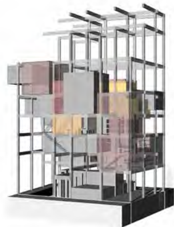
Εικόνα 24. Τελικό μόνρφωμα στιγμιότυπου με προσθήκη κατακόρυφων κινήσεων και υλικών. Εγκιβωτισμός των μονάδων μέσα στον υπάρχοντα φέροντα οργανισμό.
